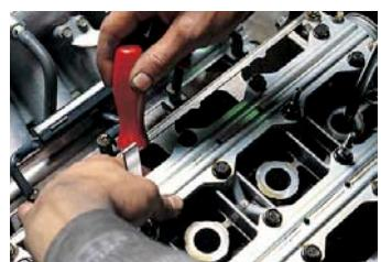
ゲージとドライバーで、適正值にバルブクリアランスを調整します。
