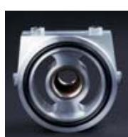
新設計センター boltにより確実な装着を実現。また、エンジン接合面にはダブルパッキンを採用しオイル漏れ等のトラブルを防止。油温センサーホールを1カ所、1/8ピッチ油圧センサーホール3カ所の配置により取付性向上を図ります。ボディには高性能の証「FEEL'S」の刻印が輝くホンダ純正オイルフィルター対応品。
