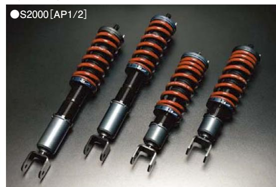
プリロードを変化させることなく車高の変更ができますのでストロークはしっかりと確保できます。つまりこの全長調整タイプとは車高を下げても乗り心地が悪くならない、跳ねない構造のダンバーキットです。ストリートでは美しいフォルムと快適なドライビング、スポーツ走行では安定した走りまで幅広く対応し、どなたにでも簡単にセットアップが可能です。シェルケースは質実剛健の「スチールタイプ」と軽量&優れた放熱性まで手に入れた「アルミケース」をラインナップ。減衰力も20段調整とワイルドな調整が可能。一部の車両にはリアの減衰調整に便利な「延長ロッド」も標準装備し、まさにホンダ専用を主張いたします。
