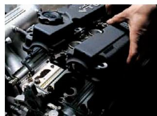
ヘッドカバーを外し、調整できる状態にします。
