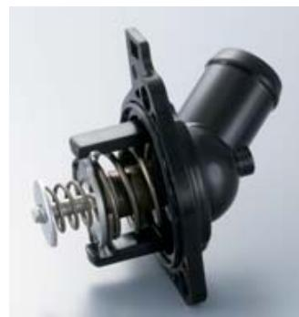
FD2用は作動温度68°C、全開温度82°Cでエンジン出力の低下を抑えます。
