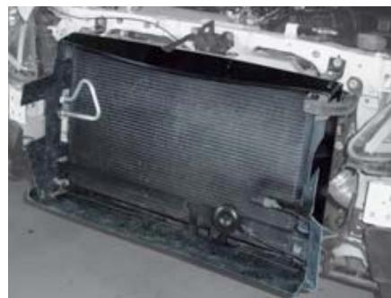
FEEL'Sスポーツバンパー専用のラジエターシュラウドカバーボックスです。バンパー内に入るフレッシュなエアーを残らずラジエターに導風することでパワーダウンを防止。
